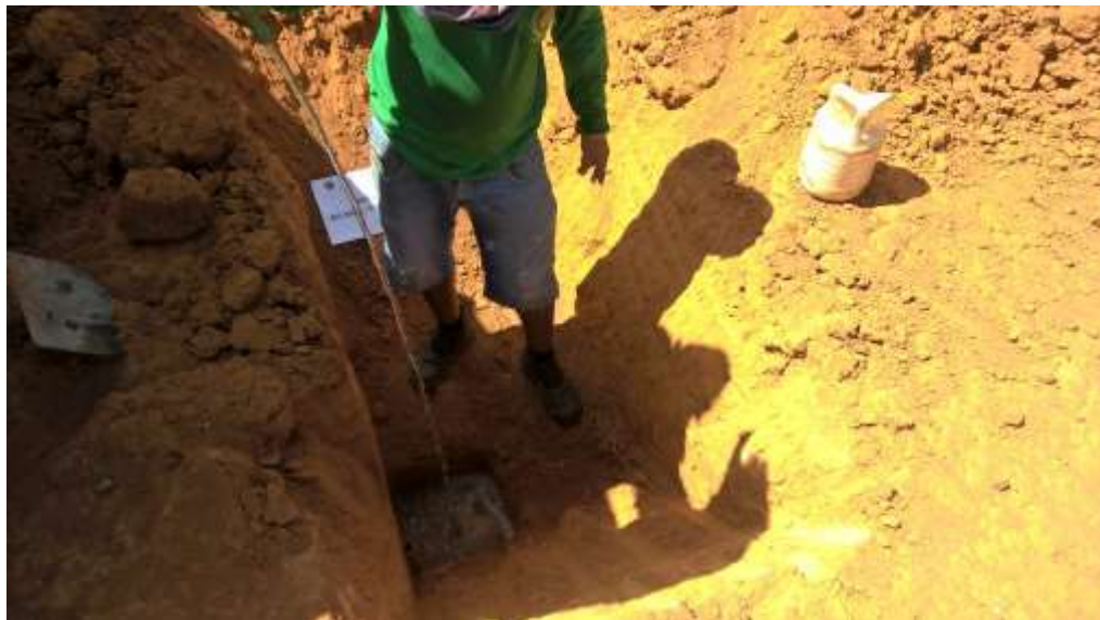
FOTO 4 – INÍCIO DO PROCESSO DE SATURAÇÃO DO SOLO.
